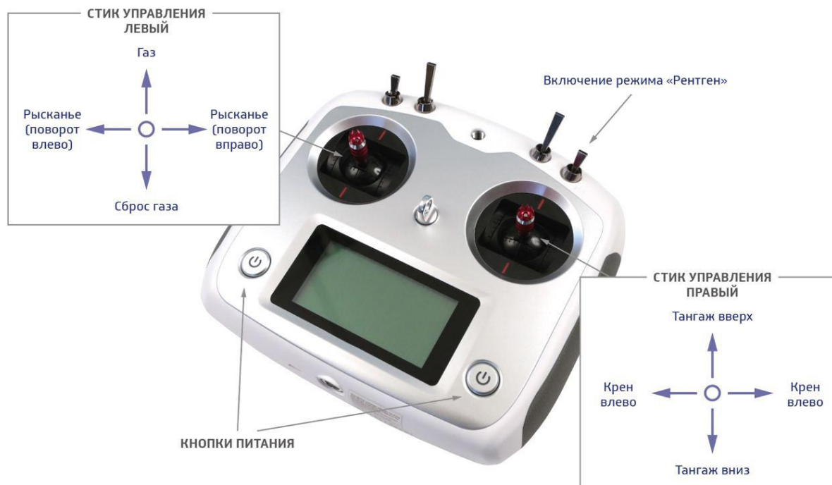
Рисунок 4 – Схема управления БВС в симуляторе с использованием пульта
